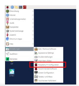
Im Menü "Schnittstellen" wird dann der "Ein-Draht-Bus" eingeschaltet.
