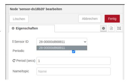
Nach Klick auf "Fertig" sieht man nach wie vor den rot gefärbten "Übernahme"-Button. Diesen bitte anklicken, dann ist der Node für den Sensor DS18B20 eingerichtet und läuft.
