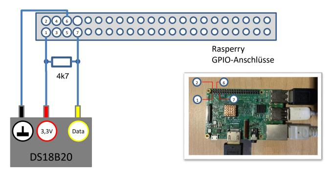
Bevor der Sensor vom Raspberry erkannt wird, muss noch eine wichtige Einstellung überprüft werden. Der Sensor DS18B20 wird über einen sogenannten 1-Draht-Bus (1Wire) mit dem Raspberry verbunden.
