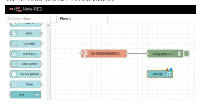
Nun muss nur noch eine Verbindung zwischen dem Sensor-Node und dem Gauge-Node hergestellt werden. Der Gauge-Node sollte auch konfiguriert werden. Dazu bitte den Node doppelklicken.
