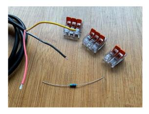
3 Verbindungskabel mit der Möglichkeit, eine Steckverbindung zwischen Raspberry und Wagoklemmen herzustellen.
