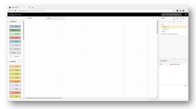
Suchen Sie sich nun im linken Bereich der "Nodes" denjenigen Node heraus, der für einen DS18B20 geeignet ist, und ziehen Sie ihn in das leere Flow-Fenster.
