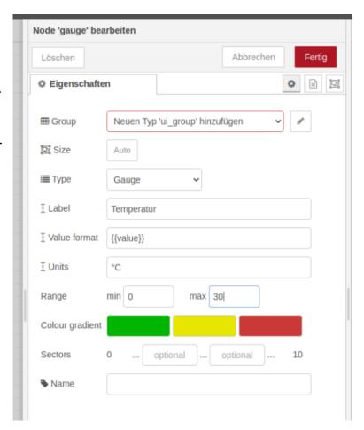
Am Ende sollte der "Gauge"-Node für die Temperaturanzeige des DS18B20 folgendermaßen eingerichtet sein:
