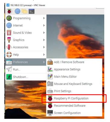
Für die Arbeit mit dem Temperatursensor "DS18B20" muss die Schnittstelle !1-Wire" eingeschaltet werden;
