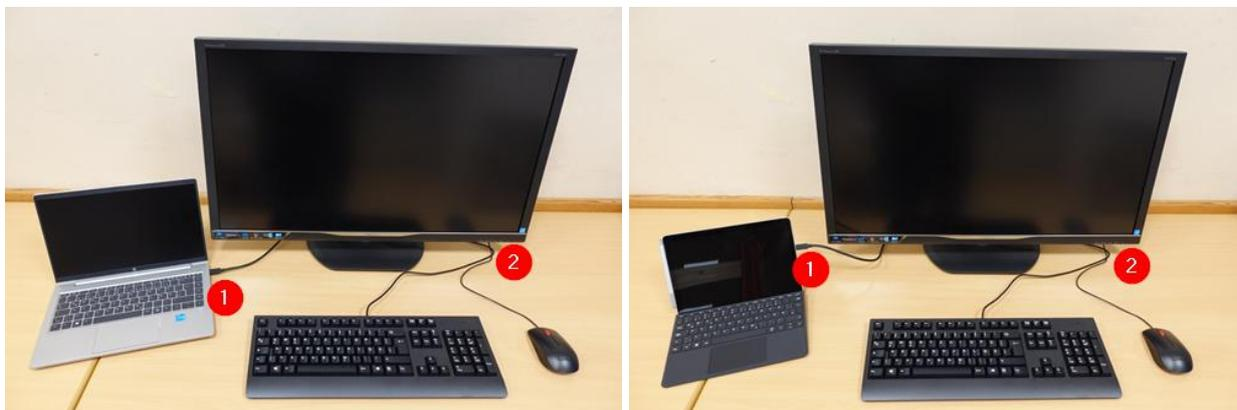
**Variante 3 (nur HP ProBook/Elitebook: Direkt-Verbindung mit Maus, Tastatur und Monitor):** An das HP ProBook/Elitebook lassen sich über die USB-Anschlüsse sowie den HDMI-Anschluss Maus, Tastatur und Monitor auch direkt anschließen. Nachteil dieser Variante ist, dass im Gegensatz zu den oben genannten Varianten am Notebook zur Vorbereitung des Arbeitsplatzes immer drei Verbindungen gesteckt werden müssen.
