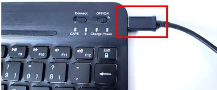
Die LED-Anzeige für den Ladeprozess (Charge) leuchtet bei Laden rot auf und erlischt wenn der Akku vollständig aufgeladen worden ist:
