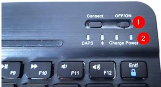
Drücken Sie im Anschluss auf der Tastatur am oberen rechten Rand die Connect-Taste (1). Die Tastatur wird in den Kopplungsmodus versetzt und die Bluetooth-Statusanzeige (2) blinkt blau auf:
